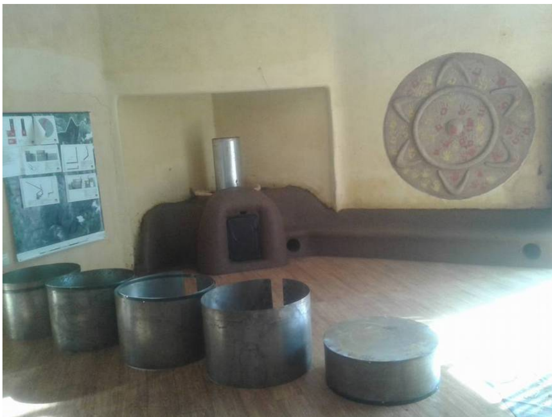
Imagen 11: Módulos de piel exterior del intercambiador
