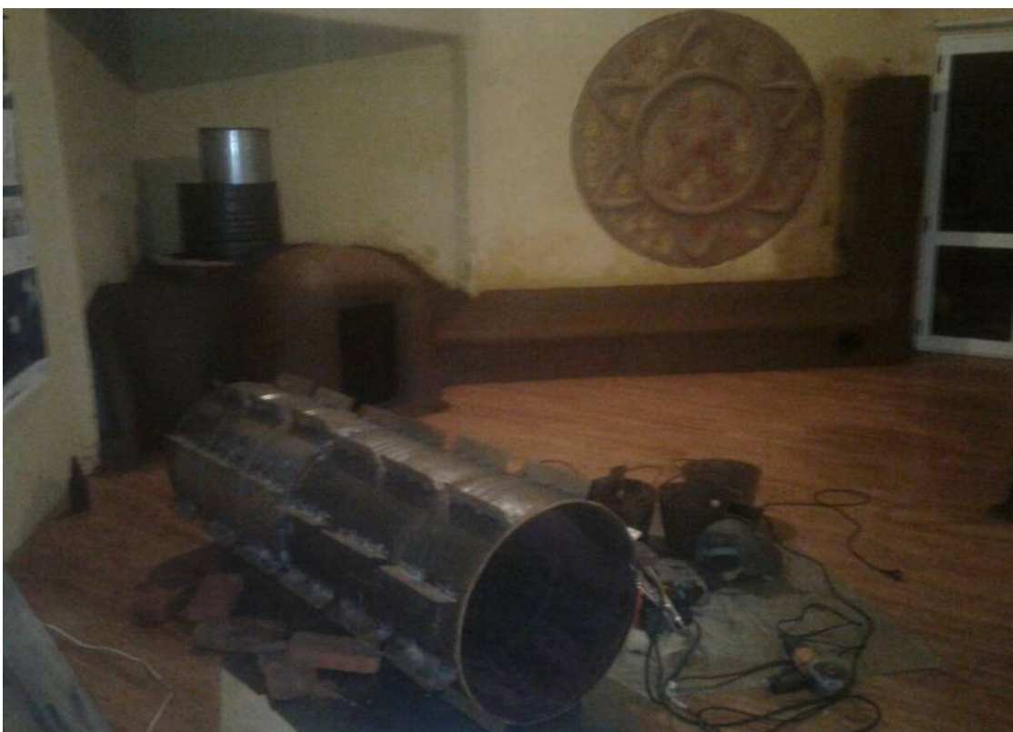
Imagen 12: Piel interior del intercambiador con aletas soldadas
